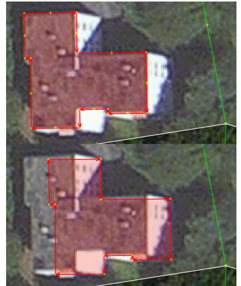
Abbildung 28: Bei perspektivisch aufgenommenen Gebäuden nicht die Dächer mappen (oben), sondern die Grundflächen (unten) – bei solchen Klotzhäusern mit Flachdächern ist das meist über eine simple Verschiebung lösbar. In hügeligen Gegenden kann so ein „schräges“ Luftbild allerdings auch durch Parallaxe ungenau sein, da für eine metergenaue Entzerrung ein sehr exaktes Höhenmodell erforderlich wäre. Eine GPS-Messung einer Fluchtlinie (nicht direkt an der Hauswand messen) gibt einen brauchbaren Bezug.
