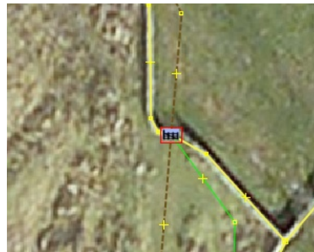
Abbildung 22: Ein Feldweg (braun) quert eine Mauer (gelb) durch ein Tor. Das Tor gehört als shared node sowohl zur Mauer als auch zum Weg.
