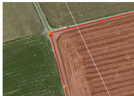
Abbildung 26: Flächenstil 2 – der geschlossene Way der Fläche wird auf die Ways der Feldwege gelegt („angeklebt“). Stil 3 sieht ähnlich aus, legt aber keinen neuem Way über die Feldwege, sondern nutzt sie selbst als Begrenzung.
