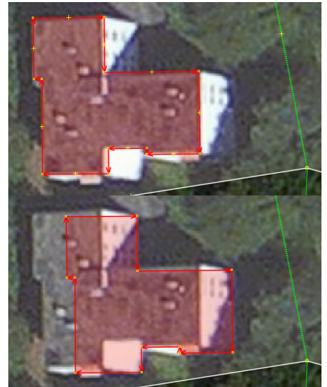
Abbildung 28: Bei perspektivisch aufgenommenen Gebäuden nicht die Dächer mappen (oben), sondern die Grundflächen (unten) – bei solchen Klotzhäusern mit Flachdächern ist das meist über eine simple Verschiebung lösbar.
