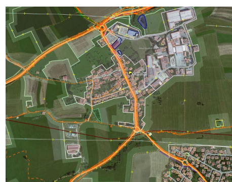
Abbildung 12: Die gesammelten GPS-Spuren vieler Benutzer (orange) ermöglichen es, das Luftbild vor dem Abzeichnen auf Versatz zu prüfen.
