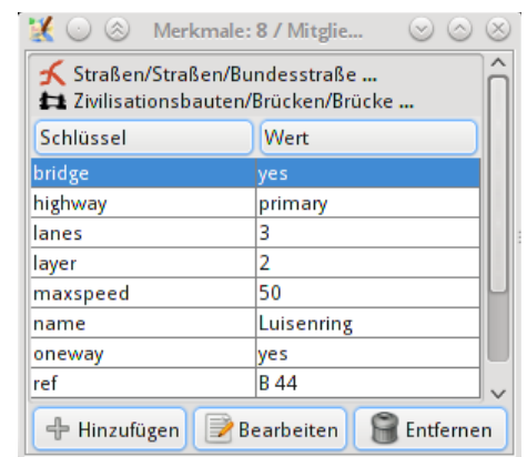
Abbildung 6: Tagging eines Straßenabschnitts des Mannheimer Luisenrings. Das physische Tag ist „highway=primary“, das diesen Way als Hauptverkehrsstraße (Bundesstraße) kennzeichnet. Außerdem führt er über eine Brücke, hat drei Fahrspuren und ist eine Einbahnstraße (die andere Fahrtrichtung ist dann ein anderer Way).
