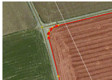
Abbildung 25: Flächenstil 1 – der Rand der Ackerfläche wird so gemappt, wie er tatsächlich verläuft. So mache ich es auch. (Die weiße Linie ist eine Freileitung.)
