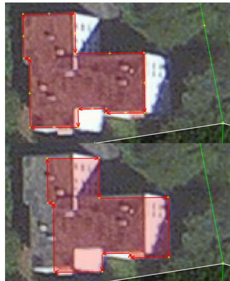
Abbildung 28: Bei perspektivisch aufgenommenen Gebäuden nicht die Dächer mappen (oben), sondern die Grundflächen (unten) – bei solchen Klotzhäusern mit Flachdächern ist das meist über eine simple Verschiebung lösbar.
