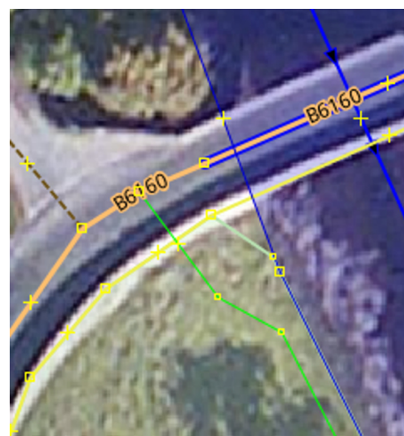
Abbildung 23: Eine Straße überquert einen Wasserlauf auf einer Brücke (blau umrandet). Abzweigungen (wie der grüne Fußweg) sollten immer an einem Node neben dem Brückenabschnitt ansetzen, nicht direkt daran. Leider ist noch nicht eingetragen, wie der Fußweg die Mauer (gelb) kreuzt.
