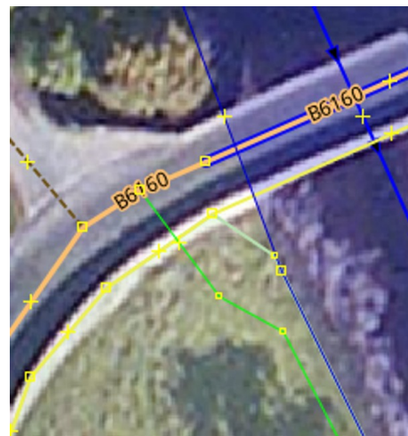
Abbildung 24: Eine Straße überquert einen Wasserlauf auf einer Brücke (blau umrandet). Abzweigungen (wie der grüne Fußweg) sollten immer an einem Node neben dem Brückenabschnitt ansetzen, nicht direkt daran. Leider ist noch nicht eingetragen, wie der Fußweg die Mauer (gelb) kreuzt.
