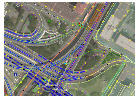
Abbildung 3: Ein Ausschnitt der Mannheimer Innenstadt in JOSM mit untergelegtem Luftbild. Straßen und Wege, aber auch Flächen, werden als Linien bzw. Kurven abgebildet. Neue Wege zeichnest du einfach mit Mausklicks ein.
