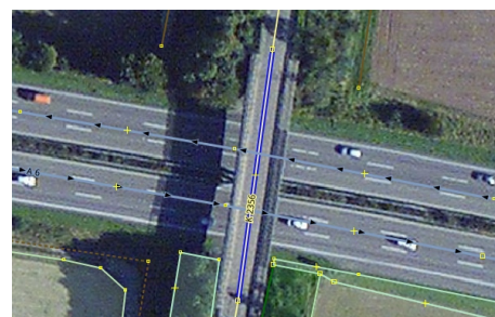
Abbildung 20: Bei Brücken dürfen auf keinen Fall shared nodes zwischen Ways auf und unter der Brücke gesetzt werden. Denn da besteht keine Verbindung.
