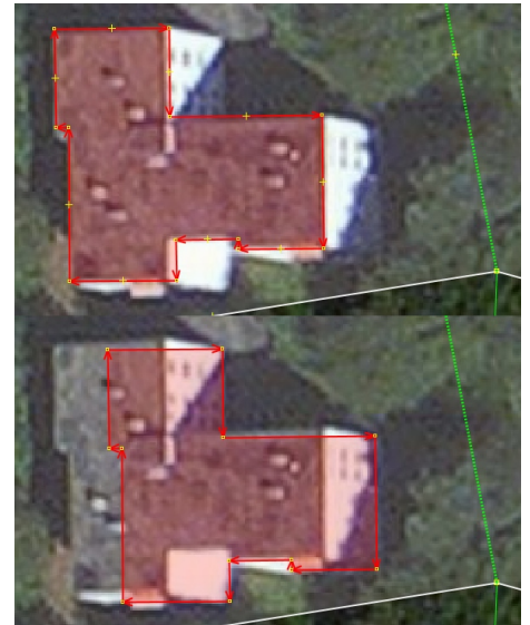
Abbildung 30: Bei perspektivisch aufgenommenen Gebäuden nicht die Dächer mappen (oben), sondern die Grundflächen (unten) – bei solchen Klotzhäusern mit Flachdächern ist das meist über eine simple Verschiebung machbar, weil Grund- und Dachfläche kongruent sind.
