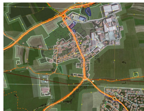
Abbildung 12: Die gesammelten GPS-Spuren vieler Benutzer (orange) ermöglichen es, das Luftbild vor dem Abzeichnen zurechtzuschieben.
