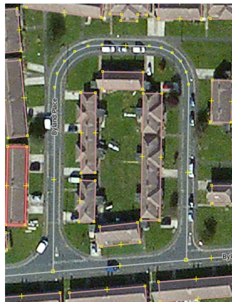
Abbildung 23: Sauber abgerundete Kurven mit JOSMs Zeichenhilfen. Die geraden Abschnitte brauchen keine Nodes unterwegs.
